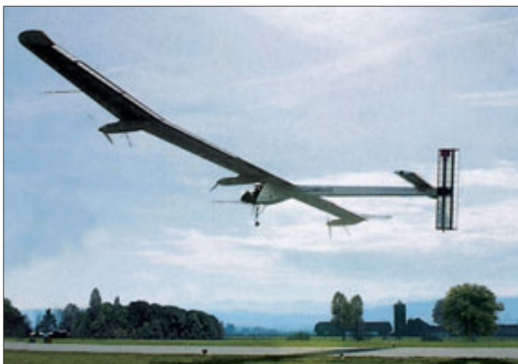
Bertrand Piccard, Sohn des berühmten Tiefseeforschers Auguste Piccard und von Herkunft Psychiater (!), baute den ausschliesslich mit Sonnenenergie, elektromotor-getriebenen Flugzeugprototyp HB-SIA. Mit ihm flog der Pilot André Borschberg, Chef von «Solar Impulse», am 7. und 8. Juli 2010 nonstop über 24 Stunden lang, also eine ganze Nacht.
